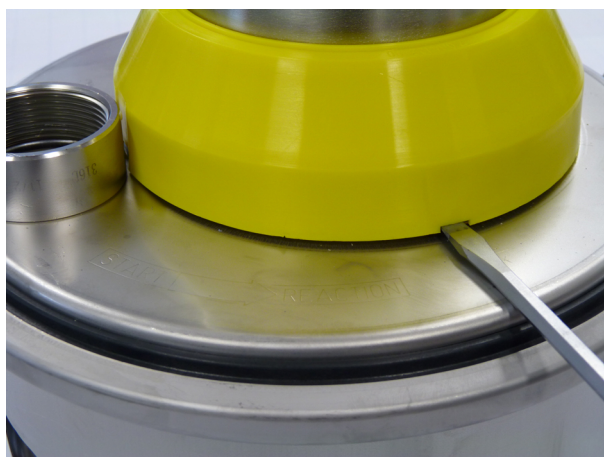
Рис. 21: Демонтаж защитного кожуха с помощью отвертки
