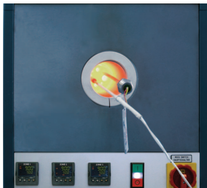
Выходной контроль кабельных термопар (калибровка) в печах, испытание целостности термогильз гидростатическим давлением
