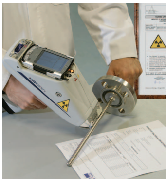
контроль качества используемых материалов идентификационным оборудованием (PMI)
