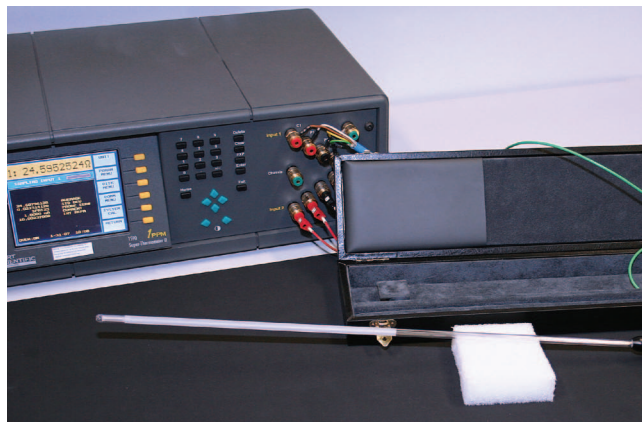
Эталонный термометр (SPRT, термометр сопротивления платиновый), калиброванный по ITS90
